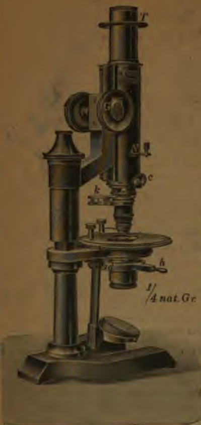
Neues einfaches Mikroskop Mod. IVa. für petrographische Studien.
